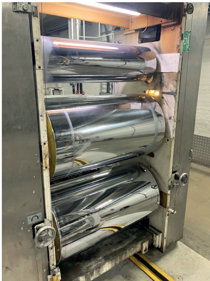
Folie Ex6 är utrustad med betydligt större kylvalsar på mellanvalsen och undervalsen.
