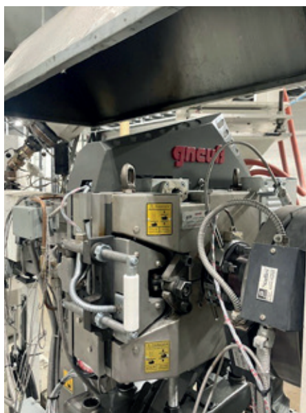
Silbytare med "Back-flush".
