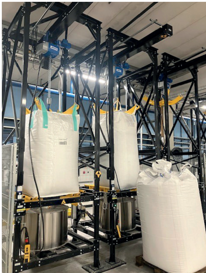
Våra nya storsäckstömmare som knådar säckarna.
