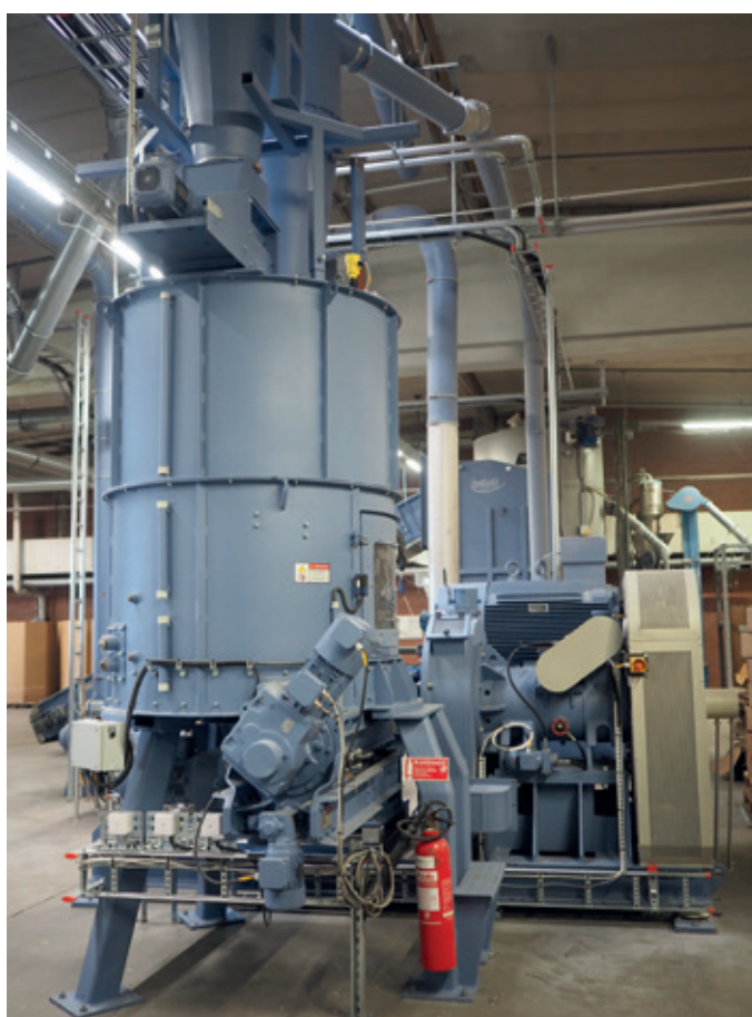
Buffertbalja – steget innan materialet kompakteras.
