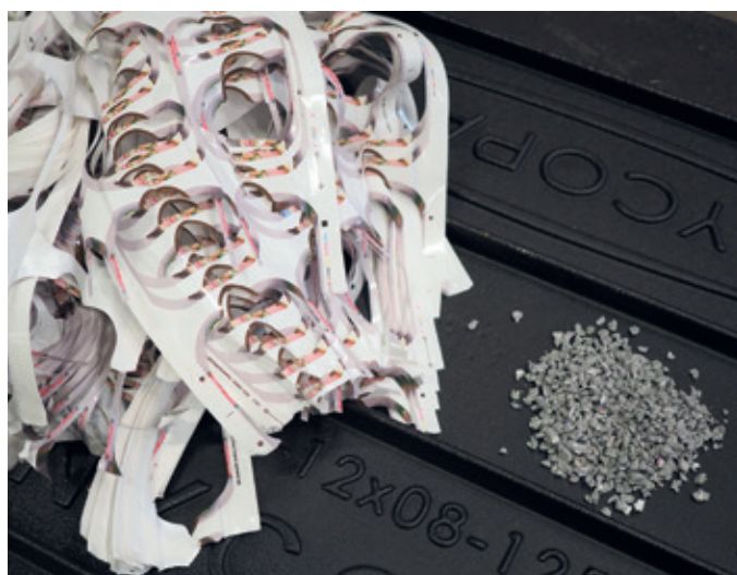
Råvara (PP C2X) före och efter bearbetning.
